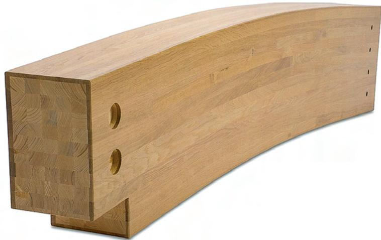
„Hess Hybrid“-Brettschichtholz-Träger zeichnen sich aus durch einen Kernquerschnitt aus Fichte oder Tanne und einer etwa 1 cm starken Umhüllungsschicht aus hochwertigem Hartholz oder einer kostbaren, dauerhaften Holzart. Der Trägerquerschnitt zeigt das charakteristische Erscheinungsbild aus Stäbchenlamellen. Foto: Hess Timber
